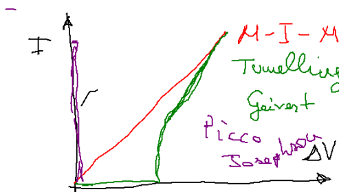
Figura 1.20: Schema della corrente in funzione della differenza di potenziale applicata sul materiale. In rosso la giunzione M-I-M, che è una retta a causa della presenza di tunnelling degli elettroni attraverso l'isolante tra i due metalli. La pendenza di questa retta (Resistenza) è data dalla probabilità di tunnelling. In verde e viola sono invece gli andamenti in una giunzione SC-I-SC.
